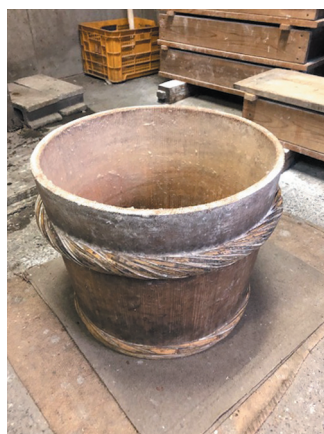
写真11 攪拌工程専用の木桶
