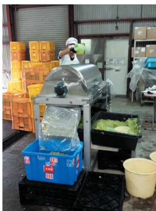
写真9 シードパルパーで果肉と種子を分離させる
