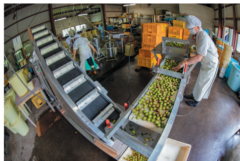
写真8 収穫した青梅をシードパルパーに送り込む
