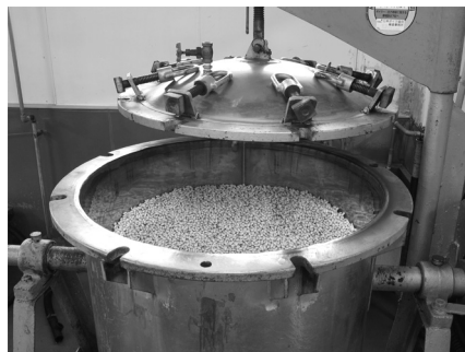
写真5 圧力釜で浸漬した大豆
