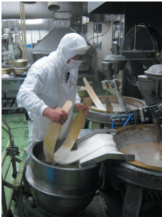
写真12 粘性が高いため自動化するよりも手作業の方が早い
