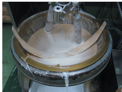
写真13 篩の枠を加工して作った道具
